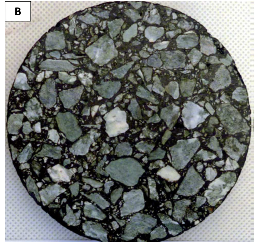
Przekroje warstw nawierzchni z mieszanek A ) o ciągłym uziarnieniu – AC 16 i B ) o nieciągłym uziarnieniu SMA 16 (fot. TPA sp. z o.o.)
